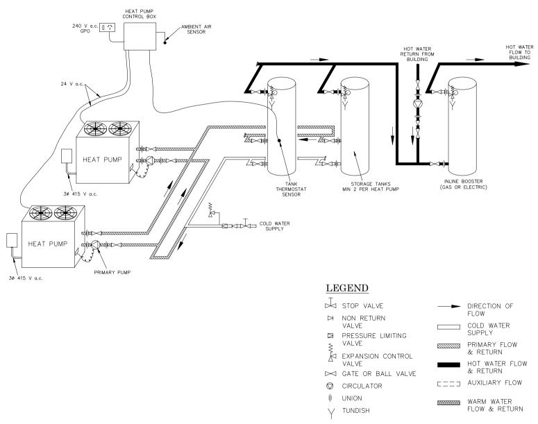
TYPICAL HEAT PUMP INSTALLATION WITH INLINE BOOST
